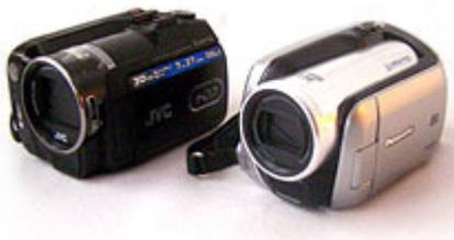
As primeiras câmeras eram analógicas. Hoje há vários tipos de filmadoras digitais. Seus componentes básicos são um CCD (Charged Coupled Device) como o das câmeras fotográficas digitais, lentes e pequenos motores que ajustam o zoom, foco e abertura. Além disso, um sistema de VCR, como nos videocassetes se encarrega de receber o sinal eletrônico e gravá-lo nas fitas magnéticas.
